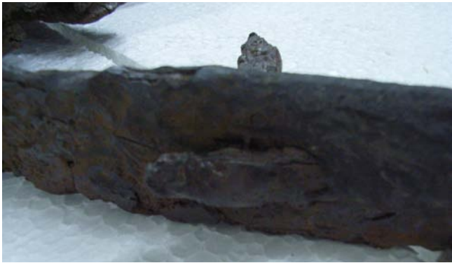
Figura 7. Pequeños apéndices que sobresalen de las cabezas de los clavos en el perímetro exterior de la llanta. Fotografía: Emma García.
