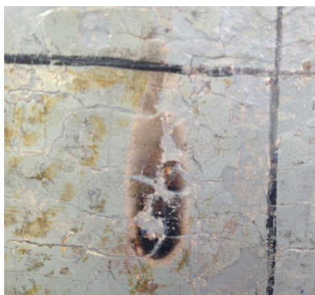
Figura 54. Quemadura producida por la proximidad de una vela. Fotografía: Cristina Salas.
