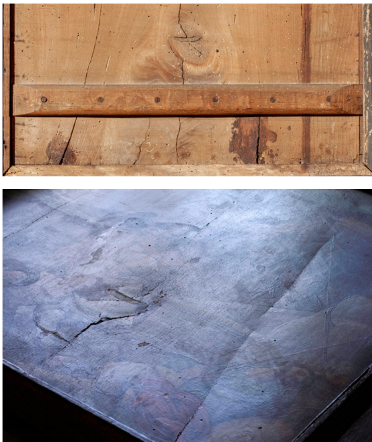
Figura 37. Fendas producidas por un embarrotado de una tabla, vistas por el anverso y reverso. Fotografía: Archivo IPCE.
