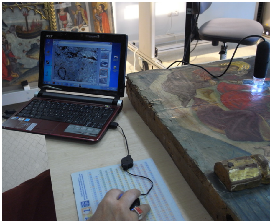
Figura 8. Estudio de una obra con microscopio USB. Fotografía: Cristina Salas Almela.
