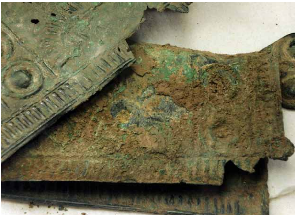
Figura 17. Estado de conservación de una de las placas de un pectoral en aleación de cobre.
