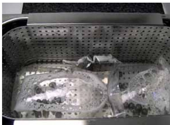
Figura 23. Limpieza mediante ultrasonidos.
