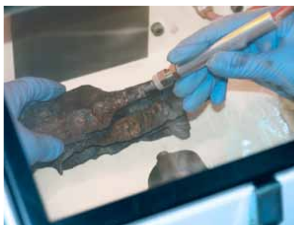
Figura 21. Limpieza con microabrasímetro y microesfera de vidrio.
