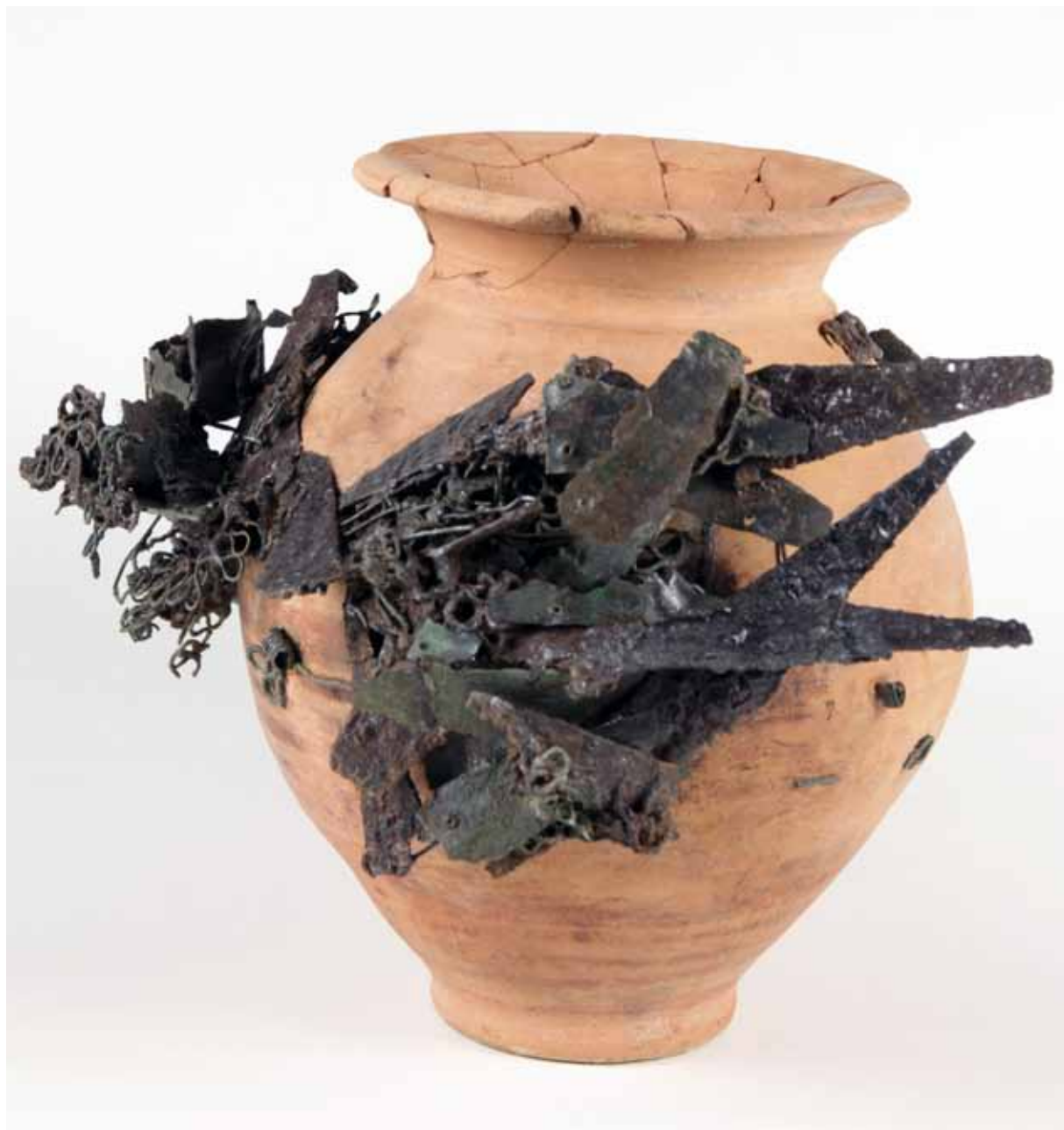
Figura 1. Un ejemplo muy poco común de objetos de hierro y bronce adheridos entre si y a un material cerámico debido a la corrosión. Museo de Albacete.
