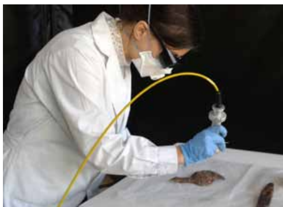
Figura 22. Limpieza mediante láser.
