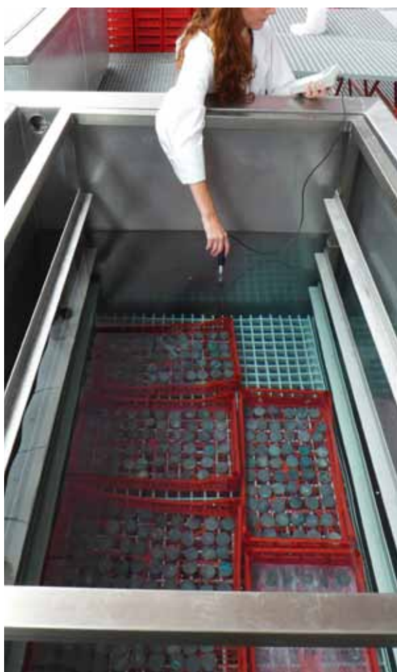
Figura 25. Decloruración. Monedas de la fragata Nuestra Señora de las Mercedes , Cartagena, Murcia. Comprobación del contenido de sales por medio de un conductivímetro.
