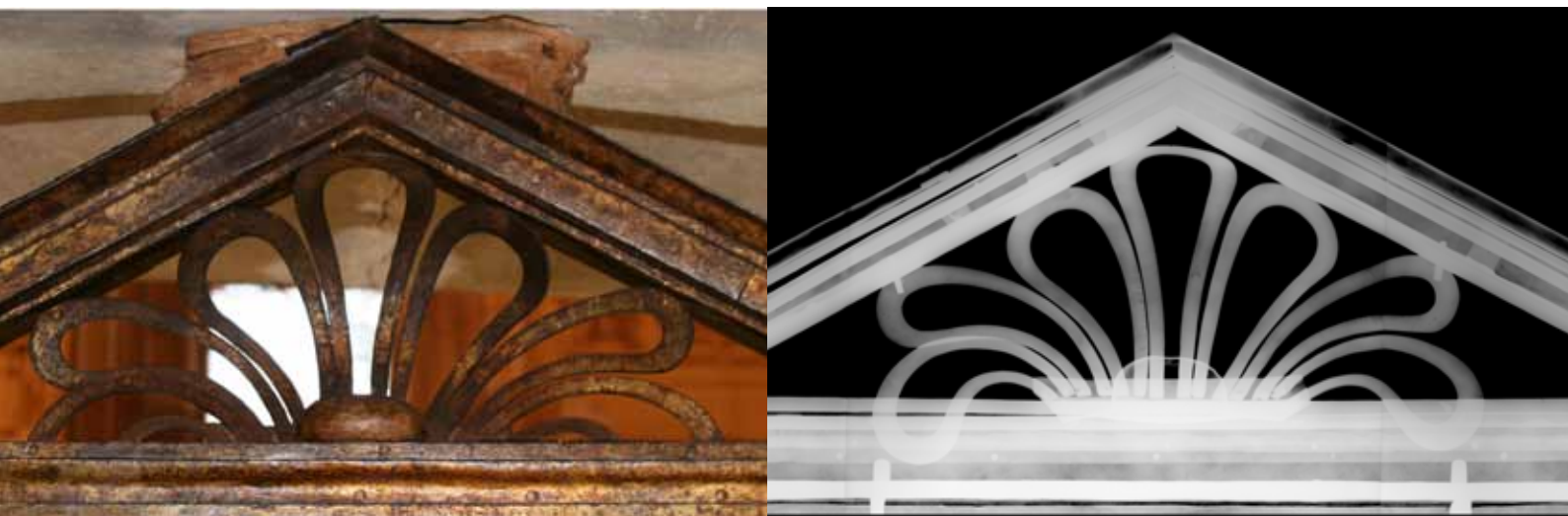
Figura 33. Imagen y radiografía de la vena donde se aprecia su fabricación con distintas piezas. Fotografía: Bárbara Hasbach.
