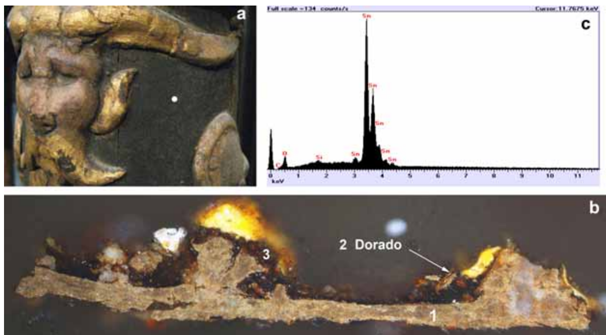
Figura 4. Microfotografía del estañado localizado en el tambor cilíndrico (a). Imagen obtenida mediante MO (b). Espectro EDX de la lámina de estaño alterada, capa 1 (c). Fotografía: Paz Ruiz.
