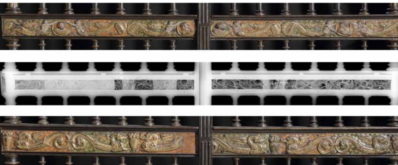
Figura 24. Imagen y radiografía de la estructura interna de la faja de la puerta. La fotografía inferior está invertida para facilitar la lectura de la radiografía. Fotografía: Tomás Antelo.
