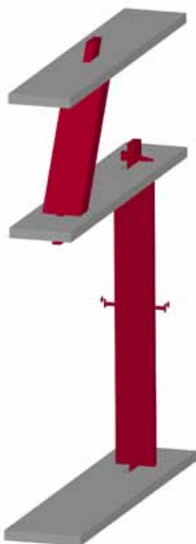
Figura 7. Esquema de ubicación de los rigidizadores. Dibujo: Javier Laguna.
