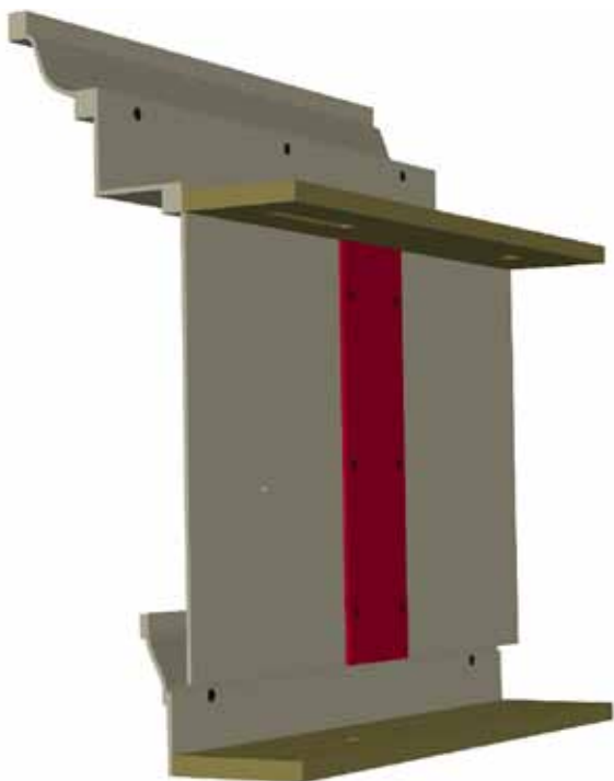
Figura 5. Esquema de la colocación de una chapa de cosido. Dibujo: Javier Laguna.
