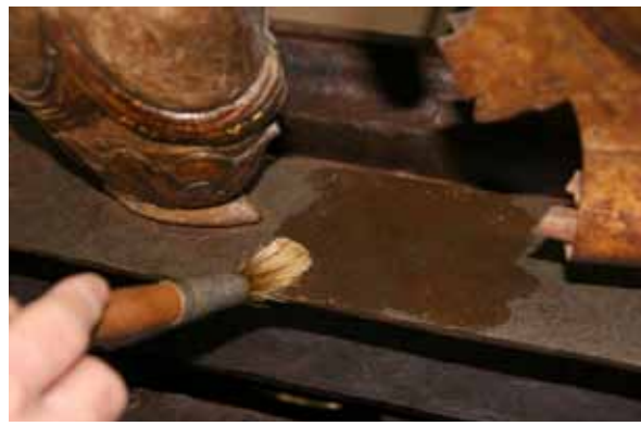
Figura 11. Tratamiento de inhibición del hierro. Fotografía: Bárbara Hasbach.
