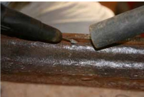
Figura 10. Eliminación de la alteración de óxidos de hierro. Fotografía: Bárbara Hasbach.
