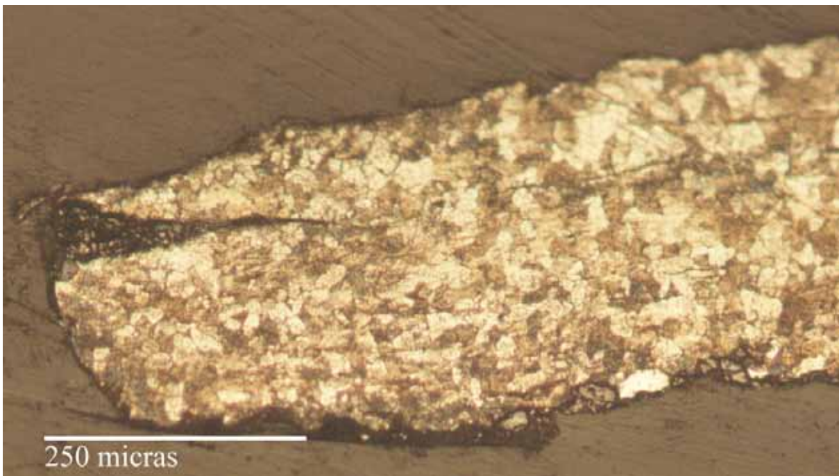
Figura 4. Fotografía de microscopía óptica de chapa de hierro de una figura decorativa pulida y atacada con nital (x10) donde se observa el afinamiento del grano.
