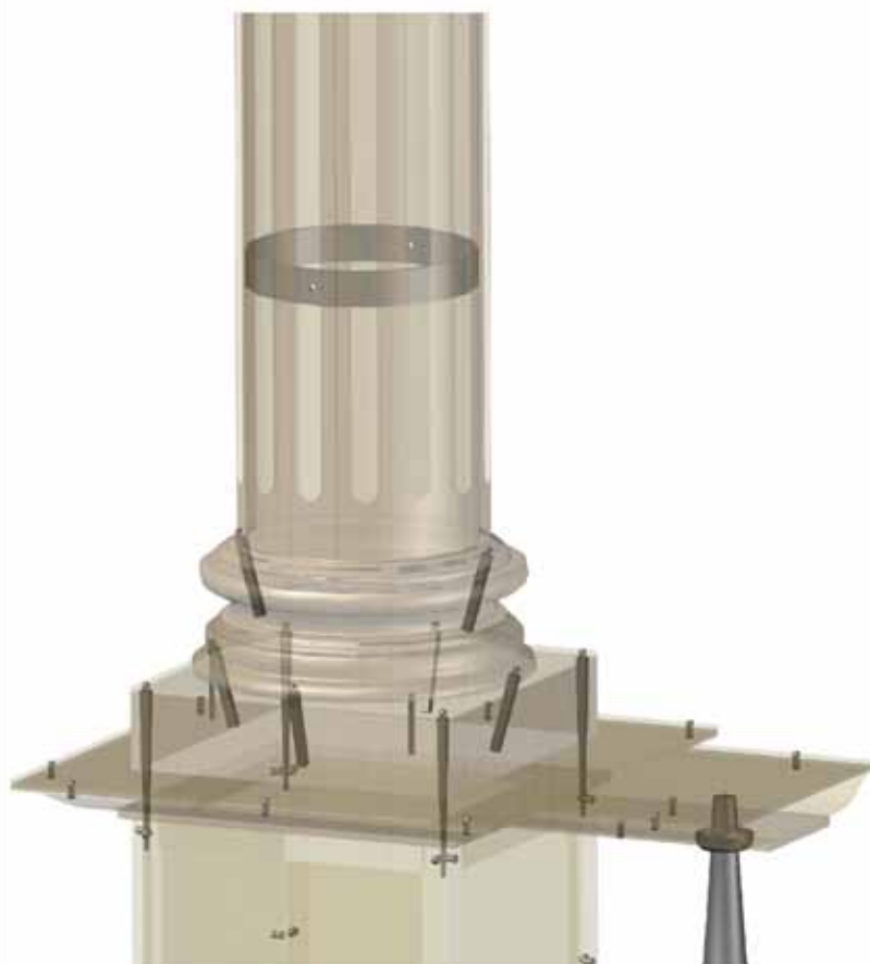
Figura 14. Radiografía y esquema del aro interno de las columnas. Dibujo: Javier Laguna.
