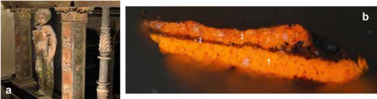
Figura 7. Microfotografía del rojo de una vestidura. Imagen obtenida mediante MO (b): 1) capa anaranjada de minio y albayalde, 2) capa parda orgánica, 3) capa de repolicromía roja que contiene minio, albayalde y laca roja. Fotografía: Dhurga Orozco.
