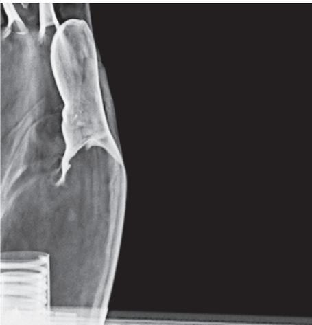
**Figura 9.** Imagen radiográfica de la soldadura bajo el dedo pulgar.
