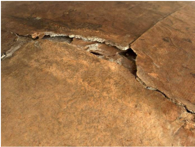
Figura 17. En la presente figura se pueden observar las deformaciones producidas por los excesos de humedad y el posterior secado de la superficie del globo, que ha hecho que la capa de estuco se desprenda del cartón, con las consecuentes deformaciones, grietas y zonas perdidas.
