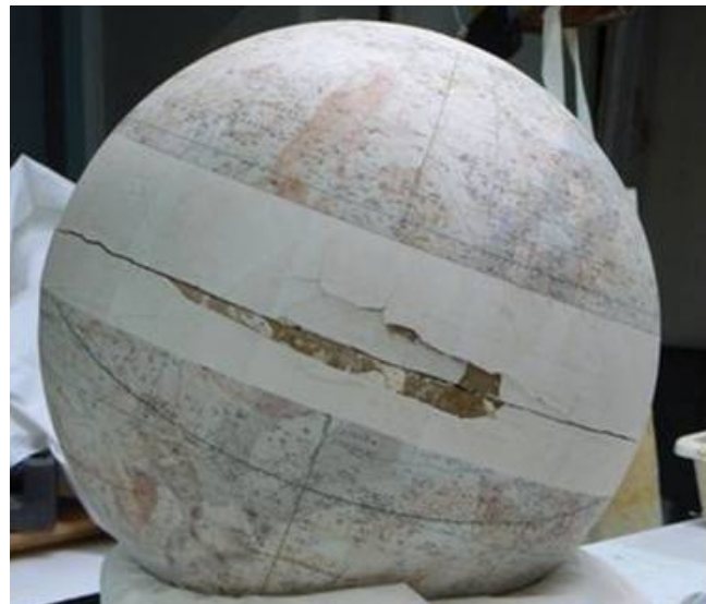
Figura 43. En ocasiones, para restaurar la estructura del globo, es necesario levantar la grafía del globo para intervenir en los soportes de cartón y estuco.
