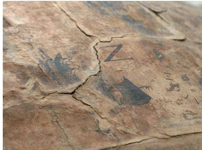
Figura 18. En ocasiones, después de un incidente por agua, la superficie de los globos aparece fragmentada en placas con grietas y pequeñas zonas perdidas; los bordes de las fisuras presentan una textura irregular como consecuencia de una antigua intervención y, al humedecerse de nuevo, las zonas afectadas se despegan entre sí –las capas de refuerzos y los originales–, dando ese aspecto abultado –resultado de dos cuerpos arrugados en la superficie lisa del globo–.
