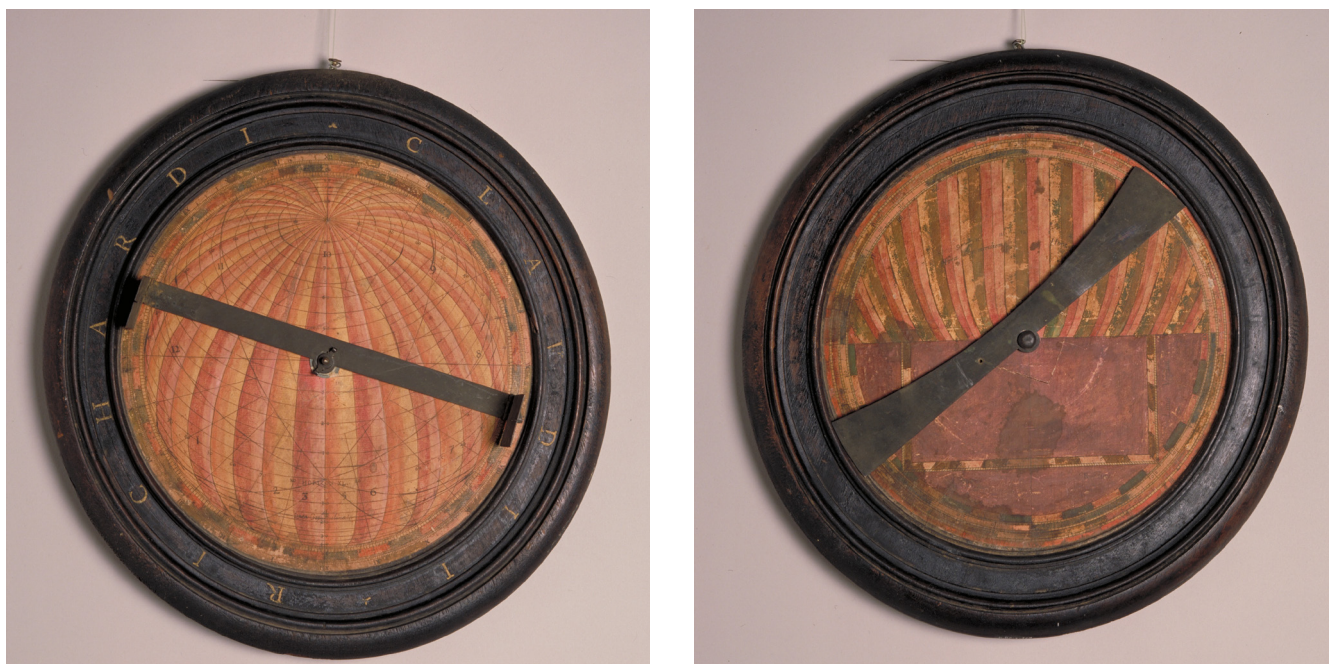
Figura 3 . Reproducción de astrolabio. N. ° inventario 1998/29/4. Original de 1630 realizado por J. Rojas, en madera, papel pintado, metal.
