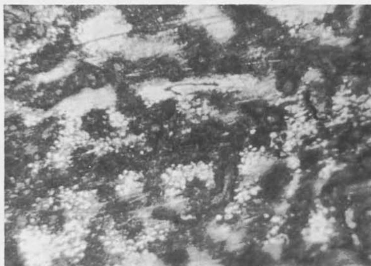
Lám. VIII. Pieza 14111. Magnificación de las dendritas de fundición (x 175).
