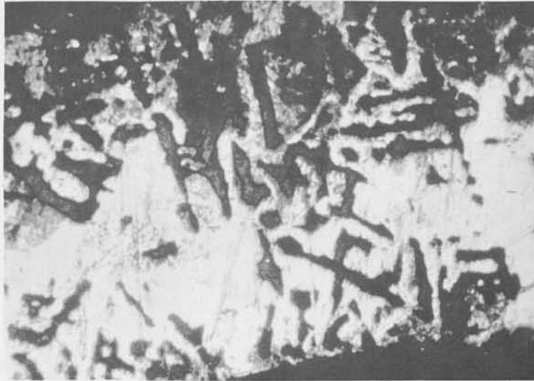
Lám. XV. – Pieza 14230. Estructura metalográfica de latón recocido: granos equaxiales de solución alfa ( $\times 175$ ).
