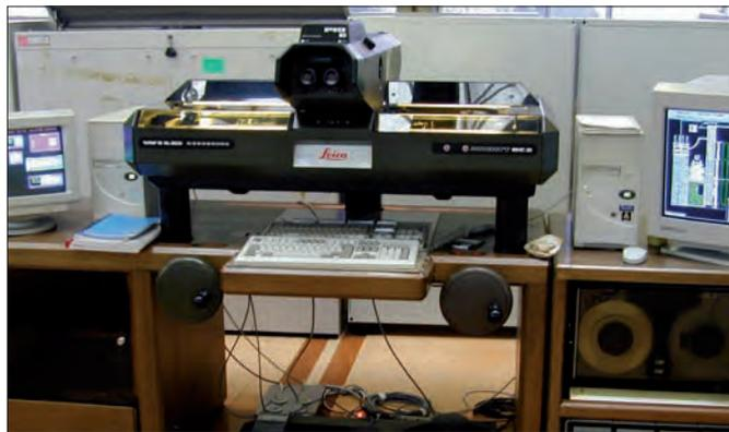
Figura 26. Restituidor Analítico.
