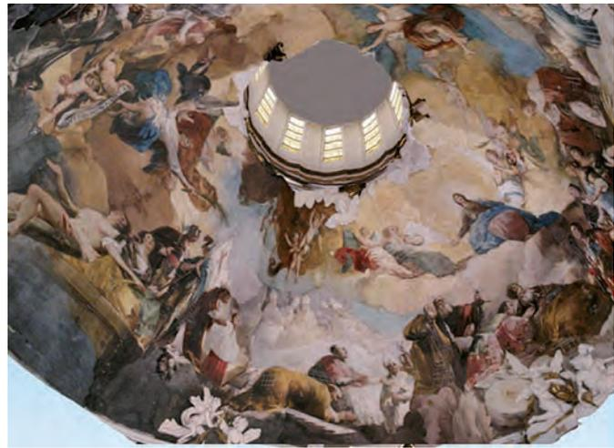
Figura 38. Visión 3D de la nube de puntos de láser y pegado de fotografías. IPCE: CT3.
