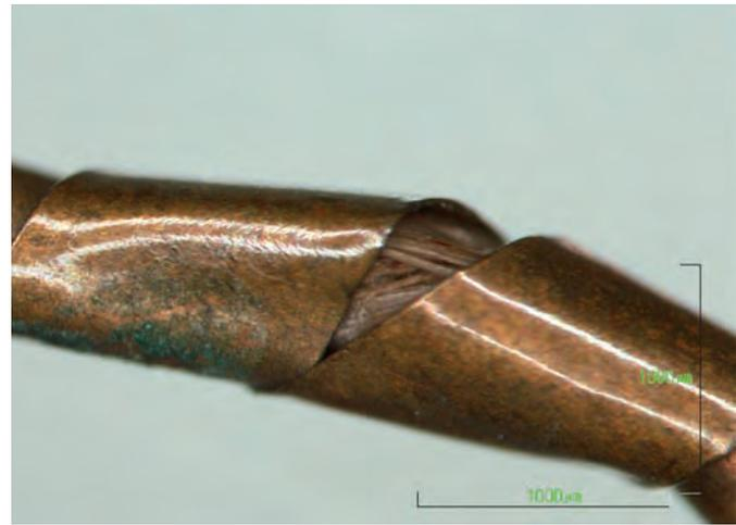
**Figura 15.** Imagen del entorchado en latón.
