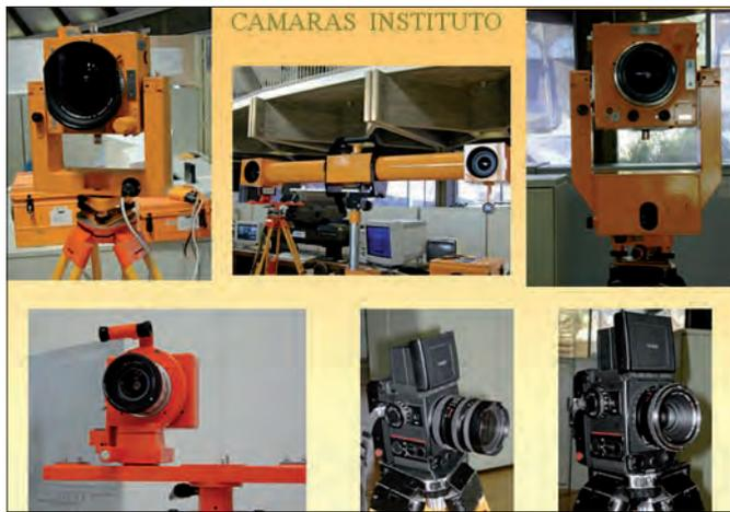
Figura 25. Cámaras métricas y semimétricas del IPCE.
