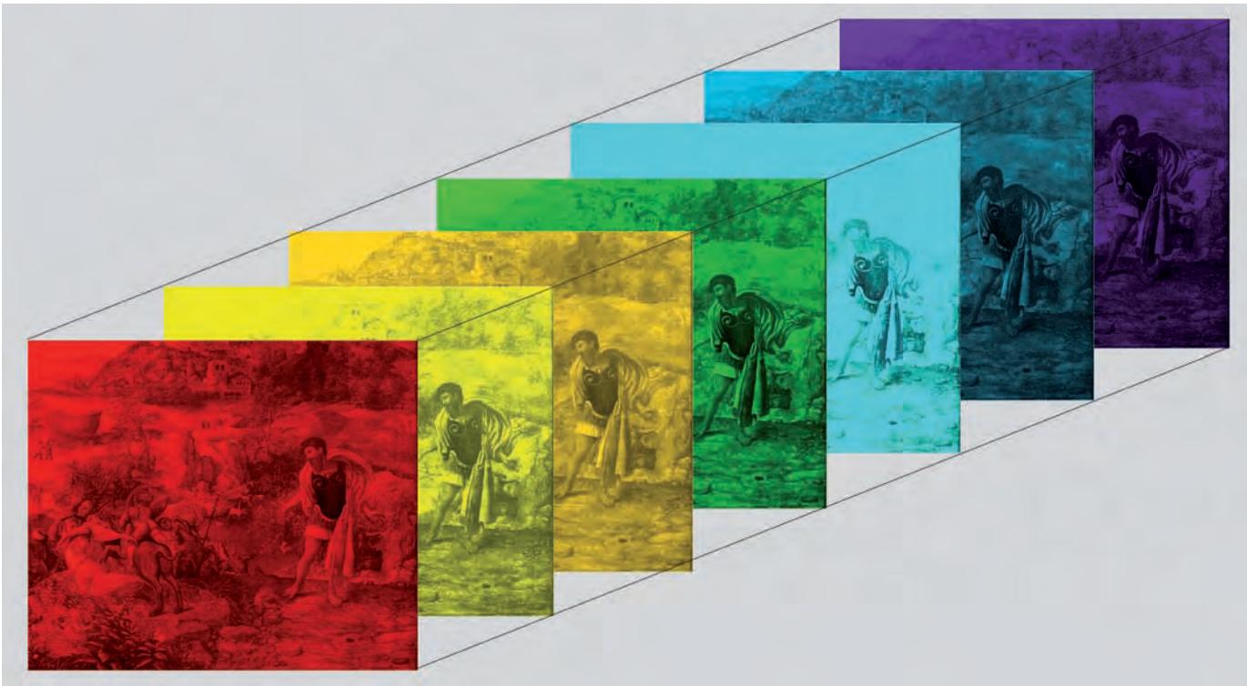
Fig. 5. Una imagen está compuesta por sus diferentes bandas espectrales. Dentro del espectro visible entre el 400nm (violeta) y 700nm (rojo).
