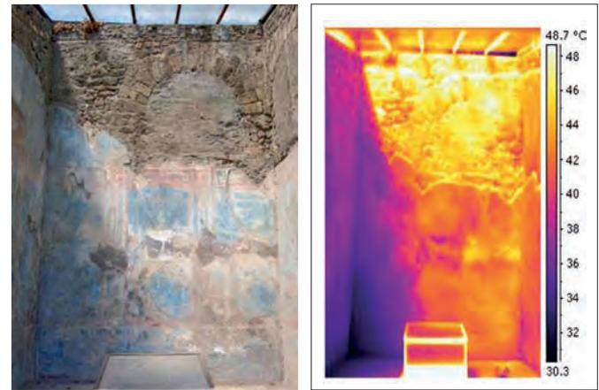
Figura 9. Casa de Ariadna: a) Exedra 22 con pintura mural y mosaicos en el suelo con el emblema en opus vermiculatum; b) Estudio termográfico de las estructuras y de las superficies.
