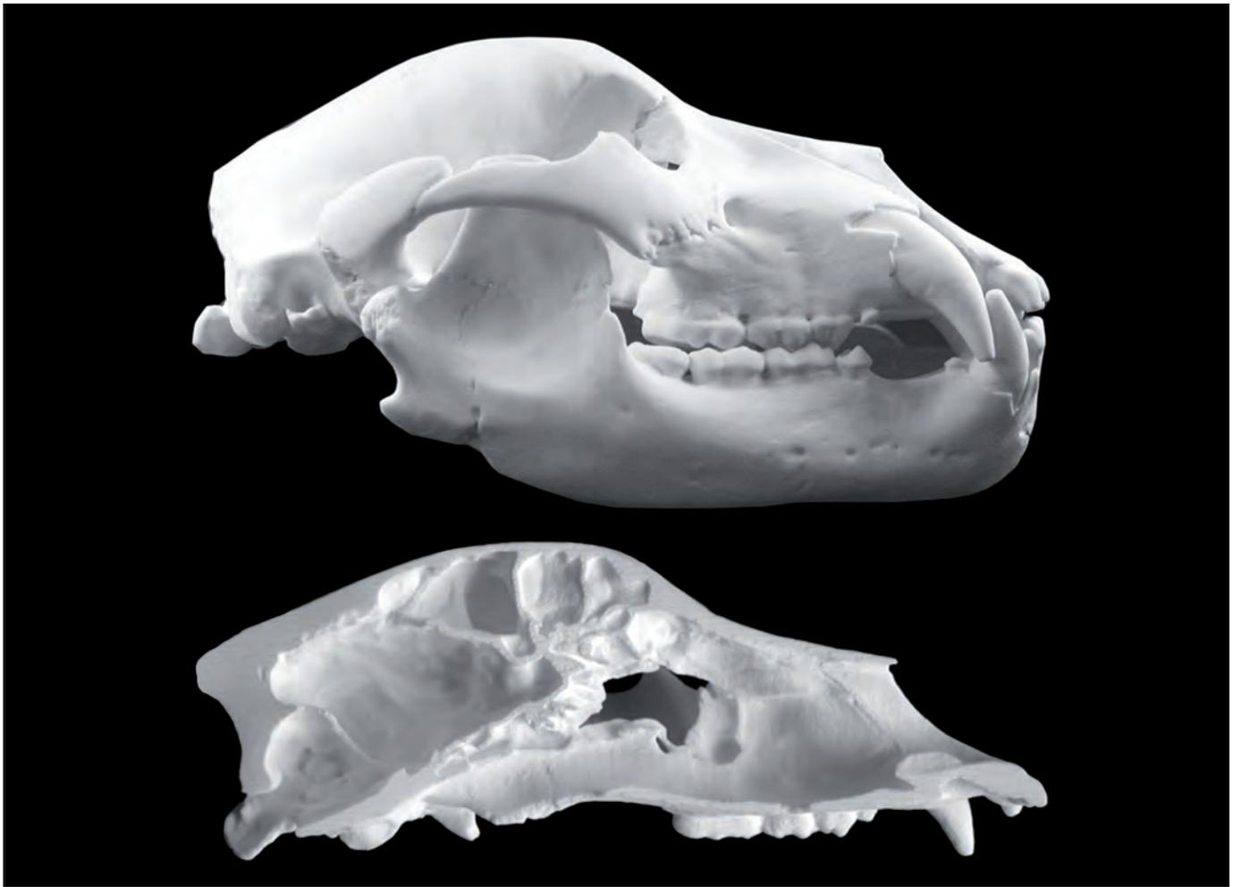
**Fig. 7.** Réplicas realizadas en la máquina de Sinterizado láser de la UBU a partir del TAC. Superior: Copia exacta (cráneo y mandíbula) de un ejemplar de oso de la Sierra de Atapuerca. Inferior: Réplica de la mitad izquierda del mismo cráneo, en la que se pueden observar las estructuras internas. Como la tomografía obtiene toda la información, se puede replicar tanto el objeto completo como partes aisladas del mismo.
