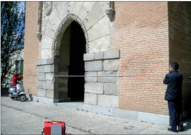
Figura 3. Medición con cinta
