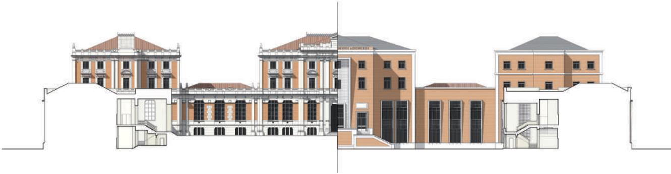
**Figura 2.** Fachada principal de la Escuela de Agrónomos. A la izquierda, fachada antes de la guerra y a la derecha, fachada reconstruida. Dibujo base del Departamento de Ideación Gráfica de la ETSAM (2007) y Álvaro Bonet (2010). Dibujo, edición y montaje posterior de Jara Muñoz (2018).
