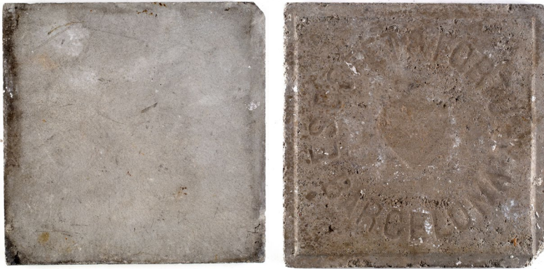
Fig. 10.- Vista del salón chaflán. Anverso y reverso de baldosa hidráulica en gris liso. Pavimento del salón chaflán, N.º inv. 28930. 20 x 20 x 2 cm. Marcas Escofet & Fortuny. Barcelona. Fotos: Archivo Histórico Museo Cerralbo y Javier Rodríguez Barrera. Museo Cerralbo, Madrid.
