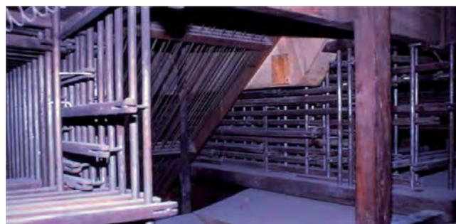
**Figura 84.** Mecánica de registros: detalle de los árboles de hierro de la mecánica de registros.
