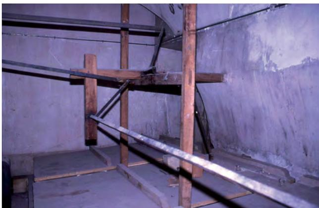
**Figura 96.** Mecanismos del sistema de alimentación: en la imagen vemos la travesa que une los fuelles tres a tres, permitiendo obtener un viento más estable.
