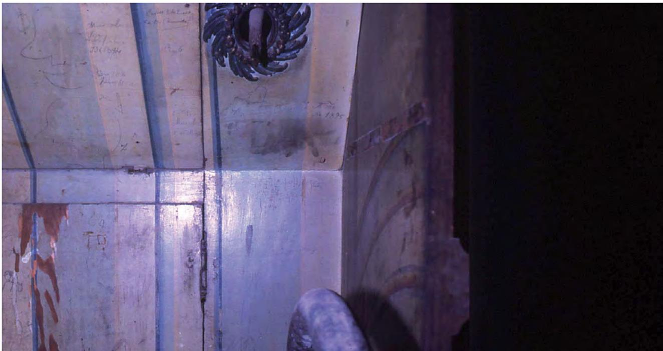
**Figura 102.** Mecanismos del sistema de alimentación: en el lateral derecho de la caja del órgano aparecen dos solecitos con un orificio por donde sale y entra la cabeza y cola de una serpiente de hierro forjado, indicando si los fuelles están o no llenos. Cara de la serpiente al interior, fuelles bajos y viceversa. Todo un ingenio.
