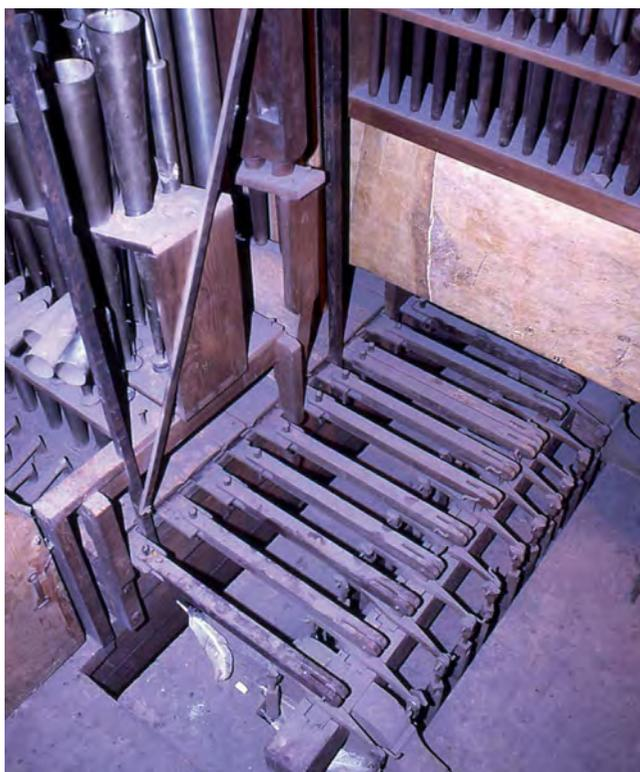
**Figura 82.** Mecánica de registros: detalle de las tracciones dobles de reenvío (parte superior) al teclado II.
