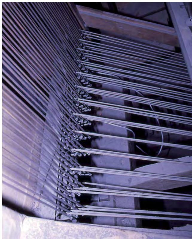
**Figura 88.** Mecánica de notas: varillaje teclado II (vista lateral).
