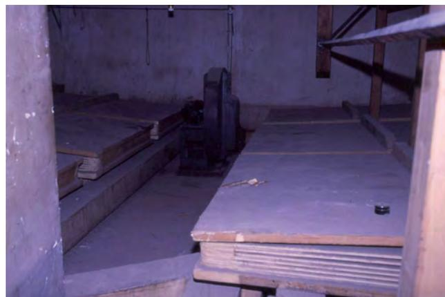
**Figura 93.** Sistema de alimentación: cuarto trasero en donde se encuentran los seis fuelles cuneiformes que sirven de depósito o pulmón del instrumento. Al fondo un enorme motor-ventilador de OESA potente y ruidoso.
