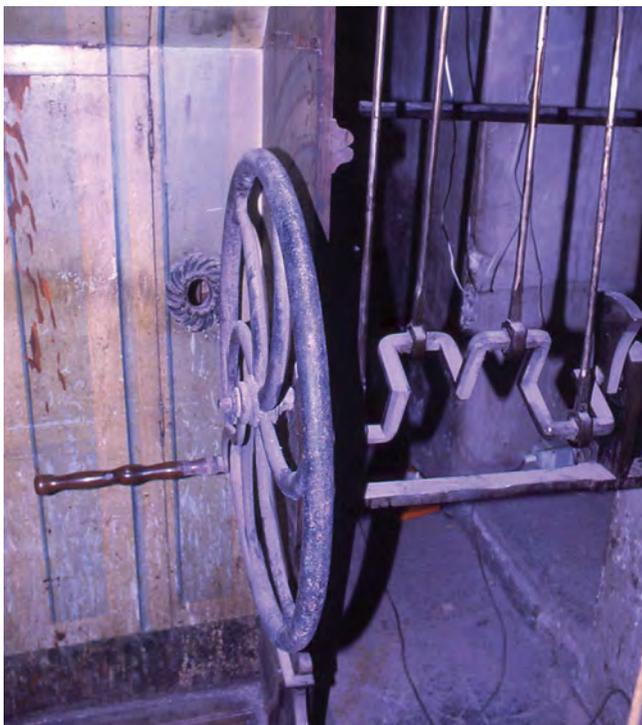
**Figura 100.** Mecanismos del sistema de alimentación: manubrio con cigüeñal con cuatro bielas que accionan los cuatro fuellecitos ya mencionados.
