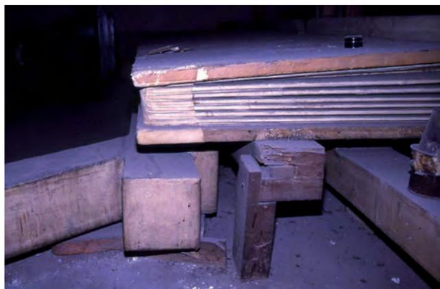
**Figura 99.** Sistema de alimentación: detalle de uno de los fuelles. Observamos el conducto general de viento que llevará el aire hasta el arca de vientos del secreto.
