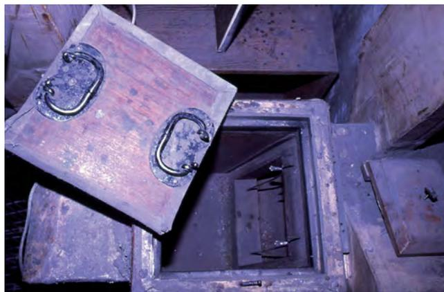
**Figura 98.** Sistema de alimentación: detalle del trémolo en uno de los conductos de viento.
