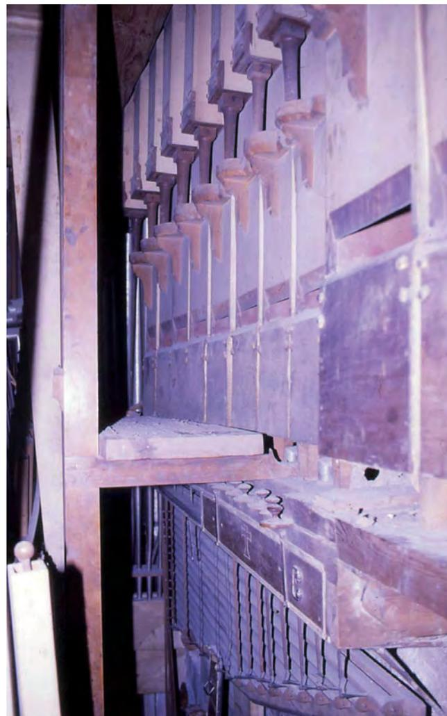
**Figura 92.** Mecánica de notas: reducción del teclado de pedal (contras, arriba).
