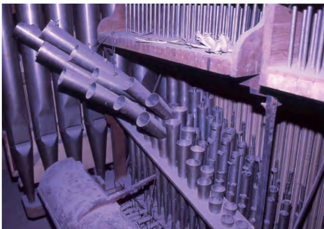
Figura 58. Teclado II: detalle del registro de bajoncillo, acodado (11 tubos).
