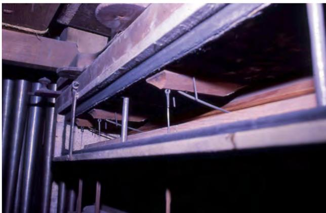
**Figura 95.** Sistema de alimentación: detalle del arca de viento del secreto de pedal. Se aprecian las ventillas.
