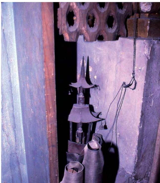
Figura 55. Detalle del registro de pajaritos (registro de adorno típico del barroco que consiste en una cazuelita a la que se pone agua y unos pequeños tubitos que cantan, «como pajaritos» cuando les llega el aire) detrás de los nazardos del primer teclado (primer piso).
