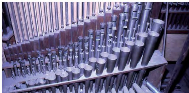
Figura 60. Teclado II: vista frontal de la cañutería citada en la vista general: los conductos que van a la corneta elevada, al fondo, flautado violón, flautado de 13 con sus entallas de afinación, clarín y chirimía alta.
