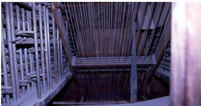
**Figura 86.** Mecánica de notas: al fondo, detalle del varillaje del teclado I y del teclado II (oblicuo).
