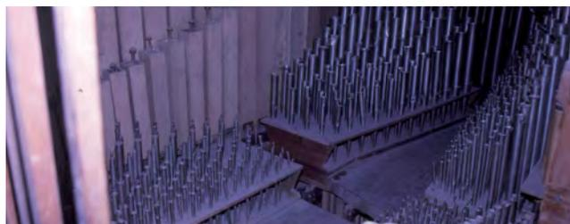
**Figura 53.** Teclado I: aquí podemos observar, con claridad, la partición de registros de m.d. y m.i.
