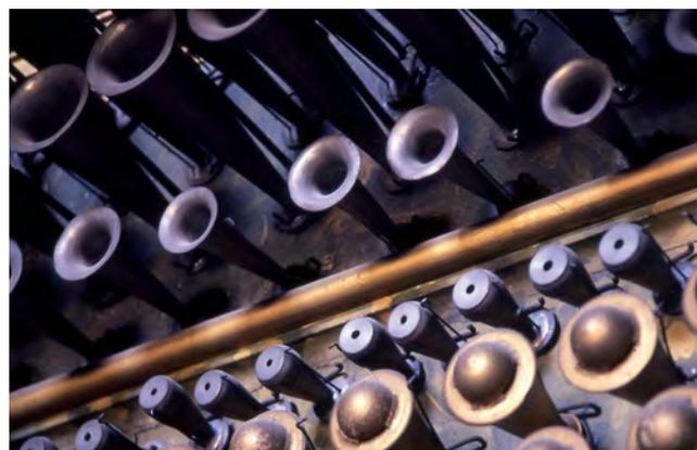
Figura 74. Detalle de registros de lengüeta de pabellón corto de la fachada.
