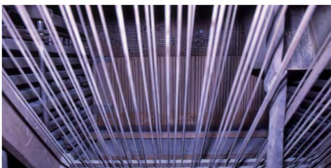
**Figura 87.** Mecánica de notas: varillaje teclado II (vista frontal).
