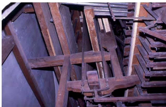
**Figura 97.** También del sistema de alimentación, pero en el interior del instrumento, podemos destacar una abundante cantidad de tablonces de conductos (de compleja factura y estructura que permiten llevar el aire a los caños del piso superior y de fachada). Vemos que están forrados y los conductos de viento hasta ellos, de plomo.
