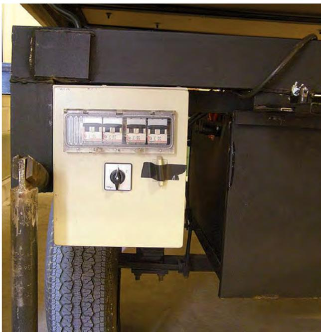
Figura 9. Cuadro de luces instalado en una carroza.
