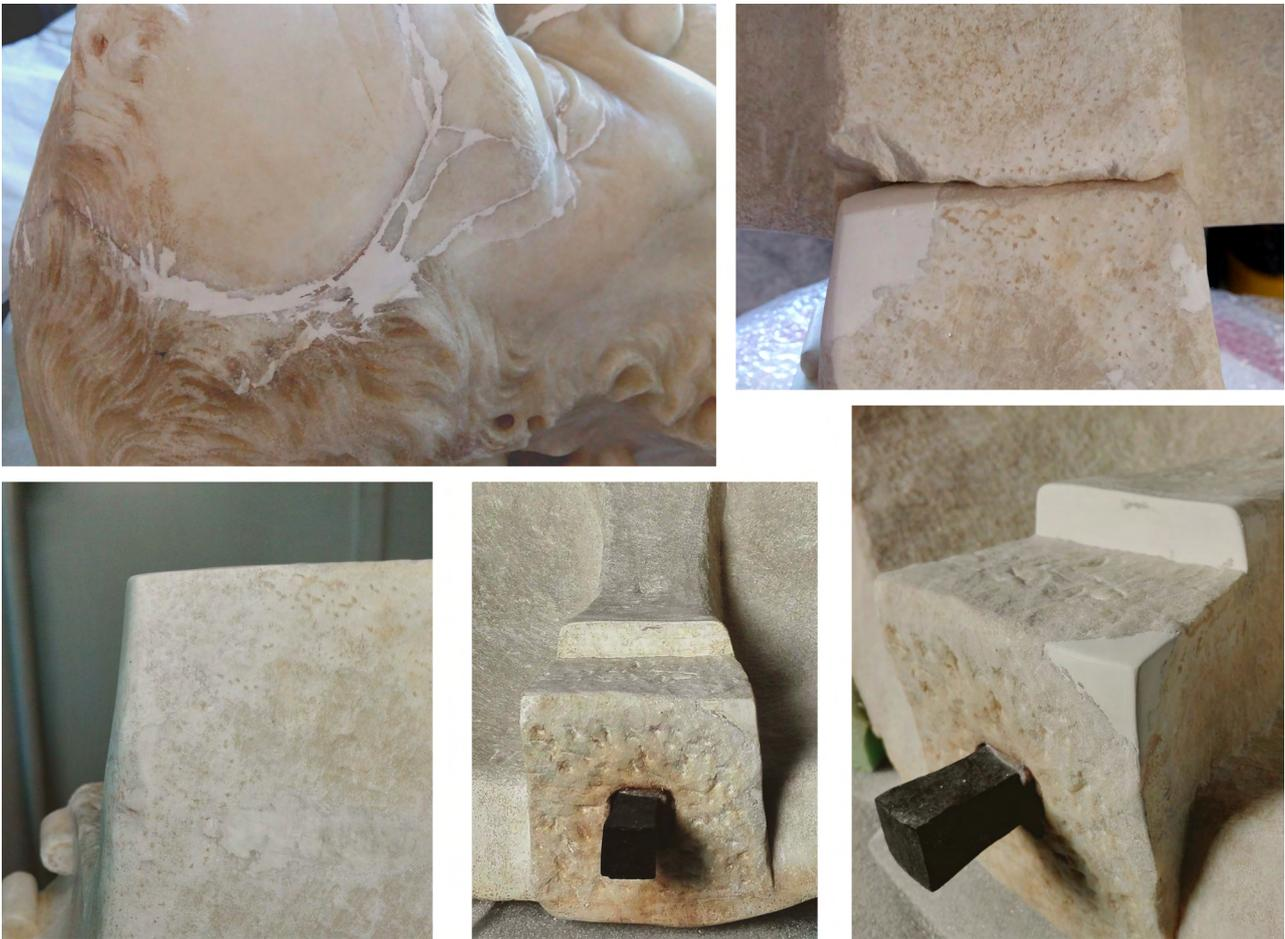
Figura 15. Proceso de reintegración volumétrica y tonal.
