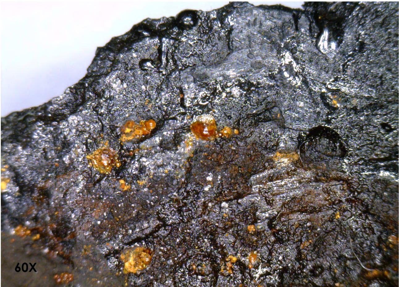
Figura 2. Focos de corrosión de oxihidróxidos y oxiclорuros de hierro activos.
