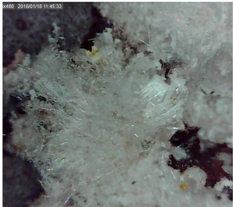
Figura 4. Paramento del Calvario. Micrografía (50x) de eflorescencias de hexahidrita sobre la zona derecha, tomada *in situ* mediante microscopio digital portátil. Fotografía: Pablo Molina.
