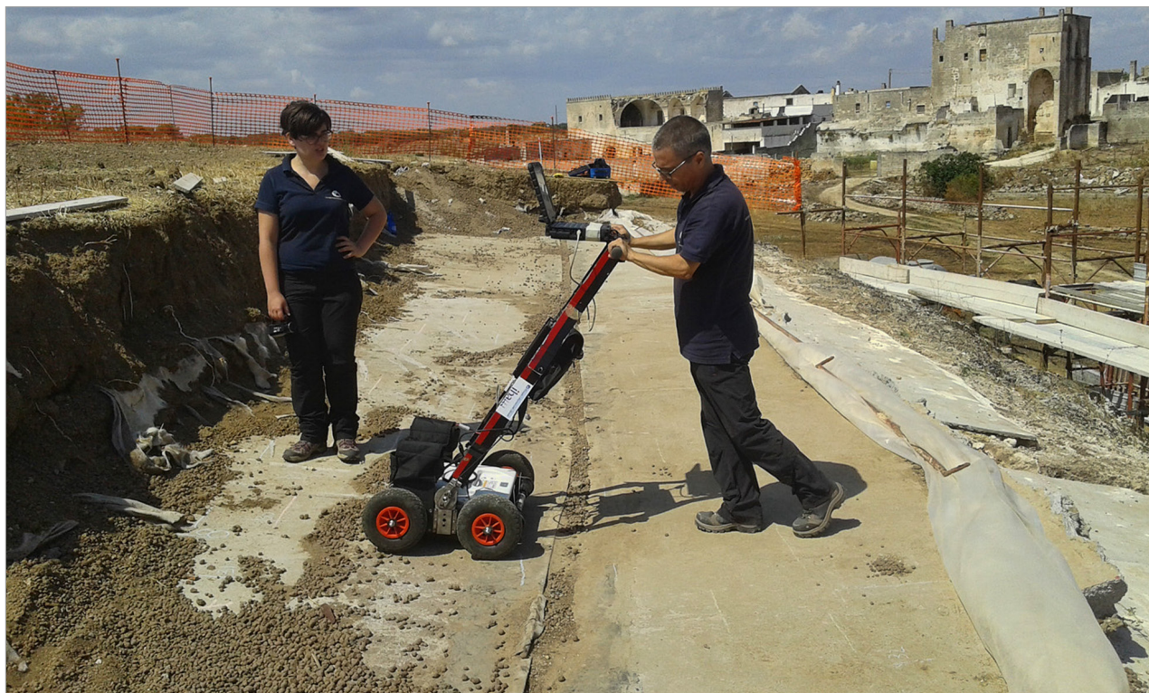
Figura 6. Investigación georradar. Fotografía: Davide Melica.
