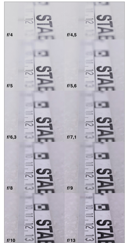
Figura 5. Distintas fotografías de una misma vista de una regla variando la apertura del diafragma donde se aprecia claramente su efecto en la profundidad de campo. Fotografía: Aleix Barberà Giné.
