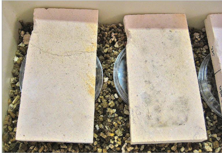
Figura 7. Dos probetas de piedra caliza Migné. A la izquierda está la probeta sin tratar y a la derecha la probeta tratada con agar. El color más oscuro corresponde a la presencia de microorganismos. Fotografía: Alicia de Lera.
