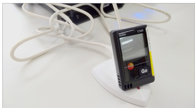
Figura 1. Data-logger marca Testo modelo 174H con cable de conexión para la descarga de datos. Fotografía: Héctor Bolívar Sanz.
