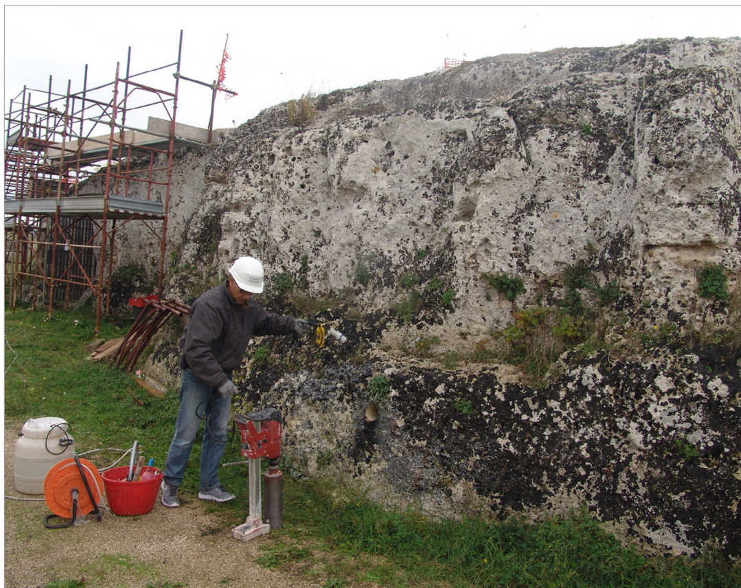
Figura 9. Perforación del banco rocoso. Fotografía: Davide Melica.
