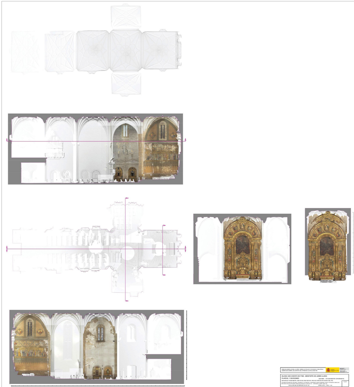
Figura 3. Iglesia de San Vicente do Pino, Monforte de Lemos (Lugo). Plantas y secciones. Escáner-Fotogrametría convergente. Fotografía: Archivo IPCE.
