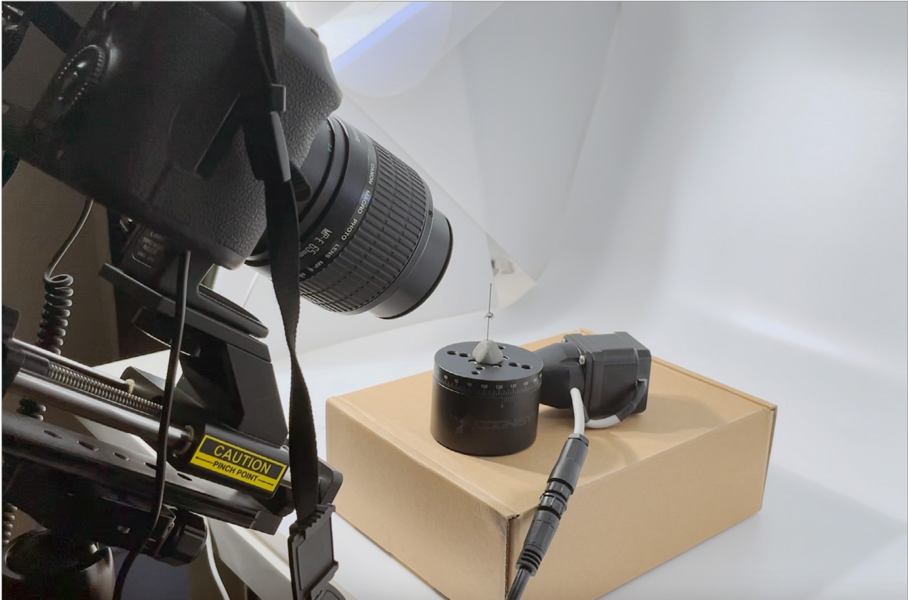
Figura 8. Muestra del montaje del equipo empleado: cámara Canon® EOS 5DS R con óptica de 65 mm macro Canon® MP-E f/2.8 montada sobre el carril micrométrico Cognisys® sobre un trípode estable. El espécimen se emplaza al centro del rotor Cognisys® dentro de una caja de luz. Fotografía: Aleix Barberà Giné.
