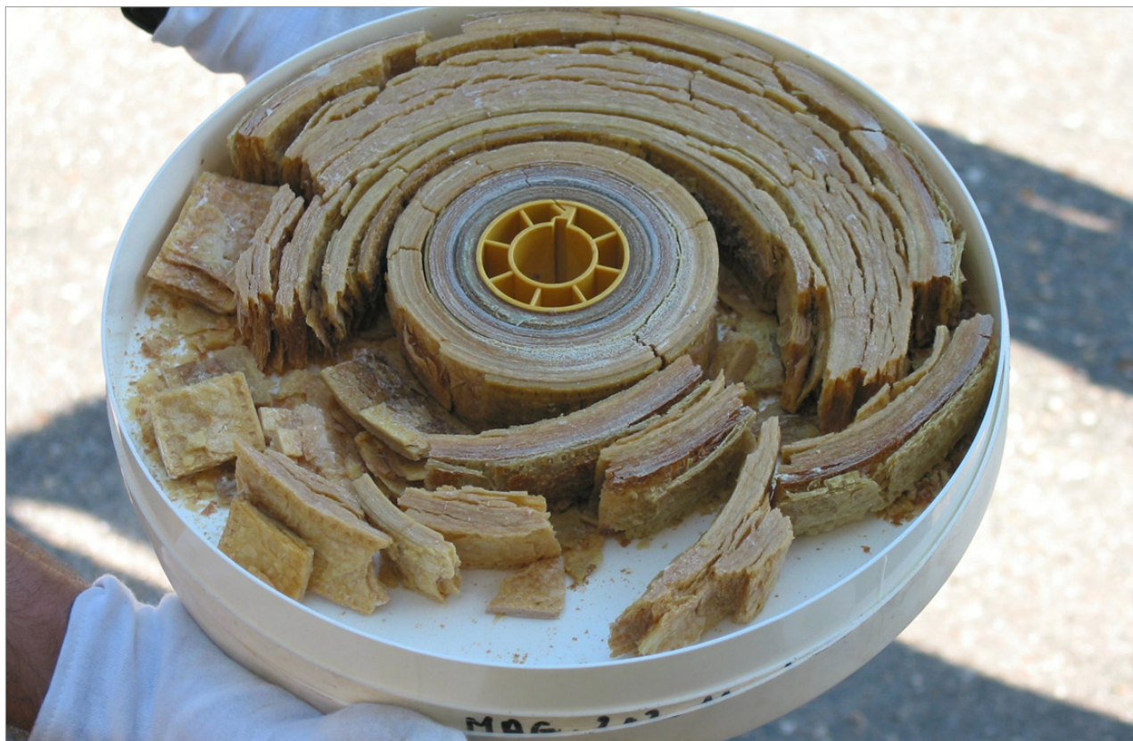
Figura 5. Degradación nítrica extrema. Fotografía: Filmoteca Española.
