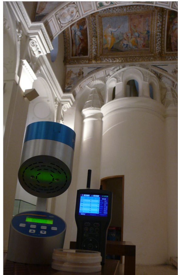
Figura 7. Vista del instrumental empleado para el estudio de aerobiología en la capilla de Luis de Lucena. Se aprecia el cabezal (de color azul) en el cual se introducen los medios de cultivo sobre los que impacta el aire tomado. Puede verse al fondo, en lo alto, el balcón de la escalera en el que también se tomaron muestras. A la misma altura, a la izquierda, se aprecia la luz procedente del óculo en el que se dispuso el pequeño sistema de extracción. Fotografía: Alexander Gaztañaga Garabieta.
