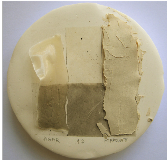
Figura 4. Probeta de yeso con tres tipos de limpieza. La mitad superior fue limpiada con láser, a la izquierda se observa el gel de agar y a la derecha la atapulgita. Ambos se dejaron secar. Fotografía: Alicia de Lera.
