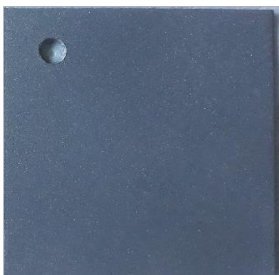
Figura 2. Probeta de acero patinable. Fotografía: Sara de Miguel Moreno.
