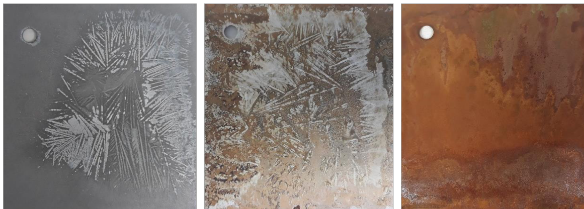
Figura 3. Probetas de acero patinable durante el proceso de patinado artificial. Fotografía: Sara de Miguel Moreno.
