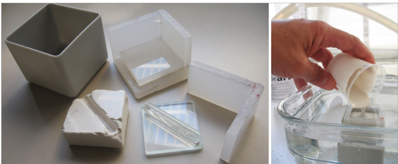
Figura 6. Cubeta, molde y cofre de encapsulado para la fabricación de probetas en laboratorio. Fotografía: Luis Carlos Zambrano Valdivia.
